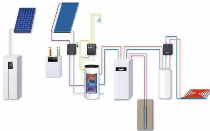
*Expliquez à l'utilisateur final, par exemple, que dans le cas d'une combinaison d'énergie photovoltaïque et de pompe à chaleur, l'utilisation d'un réservoir d'énergie thermique permet de réaliser des économies d'énergie supplémentaires*
